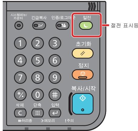
슬립 모드일 때 인쇄 데이터가 수신되면 메시지 화면이 켜지고 인쇄가 시작됩니다. 본체가 슬립 모드일 때 팩스 데이터가 수신될 때에도 자동으로 정상 모드로 복구해서 인쇄를 시작합니다.
