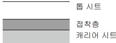
라벨지는 그림과 같이 세 개의 층으로 구성됩니다. 접착층은 본체에 적용된 힘에 의해 쉽게 영향을 받는 재질을 포함합니다. 캐리어 시트는 라벨이 사용될 때까지 톱 시트가 부착되어 있어야 합니다. 이러한 라벨지의 구조는 많은 문제를 야기할 수 있습니다.
