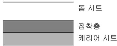
라벨지는 그림과 같이 세 개의 층으로 구성됩니다. 접착층은 본체에 적용된 힘에 의해 쉽게 영향을 받는 재질을 포함합니다. 캐리어 시트는 라벨이 사용될 때까지 톱 시트가 부착되어 있어야 합니다. 이러한 라벨지의 구조는 많은 문제를 야기할 수 있습니다.
