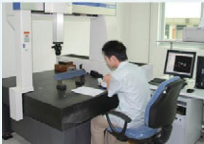
出荷検査で3次元測定器を使って寸法を測定
