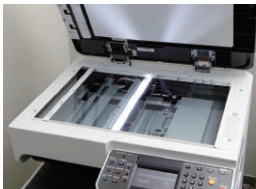
原稿スキャンユニットの光源に白色LEDを採用し、従来のキセノンランプに比べて消費電力を約1/5に削減。
