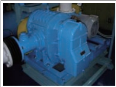
玉城工場トナー製造ラインに更新された、インバータ制御のルーツ式ブロア
