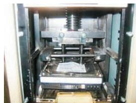
HDD 破壊装置
